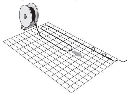
**4 I enden av en rett lengde, snu kabelen 180 grader og legg kabelen i motsatt retning med ønsket avstand.
