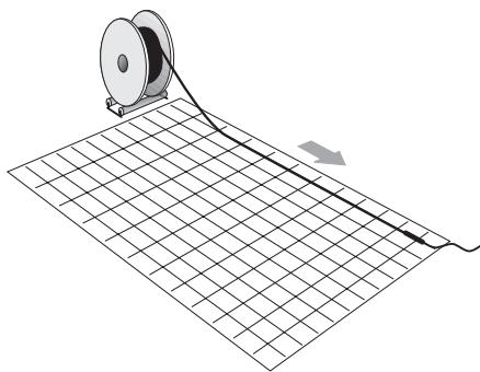
2 Потяните греющий кабель со стороны соединительной муфты в направлении подсоединения холодного ввода к электрической сети
