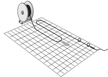
4 Na konci přímého úseku otočte kabel o  $180^\circ$  stupňů a instalujte kabel v opačném směru v odstupu požadované rozteče. Pokračujte v upevňování topného kabelu k výztužnému pletivu v intervalech po 100 mm, dokud není kabel zcela připevněn a požadovaný povrch není vhodně pokryt.
