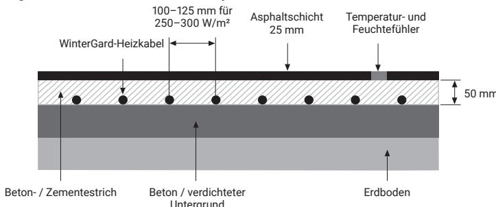
Wenn das Heizkabel nicht auf einer Bewehrungsmatte angebracht werden kann, sollte der Installateur Kabelabstandshalter (für Asphalt: Metall VIA-SPACER) anbringen, um gleichmäßige Heizkabelabstände zu gewährleisten.
