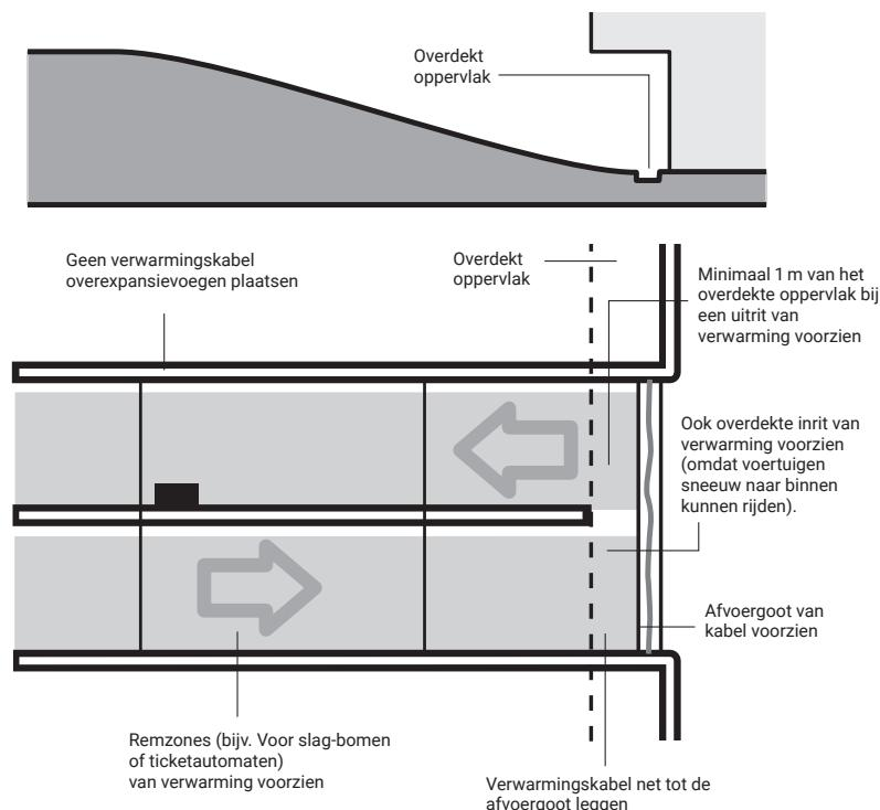
Controleer eerst of het te verwarmen oppervlak overeenstemt met de gegevens van de ontwerpinstucties. Bepaal waar de aansluitdozen geplaatst moeten worden en controleer of de aansluitkabels lang genoeg zijn (5 m).
