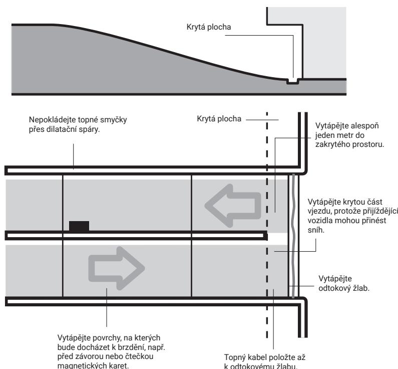
Nejprve se ujistěte, že vytápěná plocha odpovídá údajům uvedeným v návodu k projektování. Stanovte, kde mají být instalovány připojovací krabice, a zkонтrolujte, zda jsou připojovací vodiče dostatečně dlouhé.
