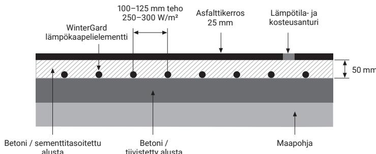
Jos lämpökaapelia ei voida asentaa raudoitusverkkoon, asentajan pitää käyttää muovisia kiinnitysnauhoja (asfalttia varten metallinen VIA-SPACER) tai muuta kiinnitysmenetelmää yhdenmukaisten asennusvälien säilyttämiseksi.
