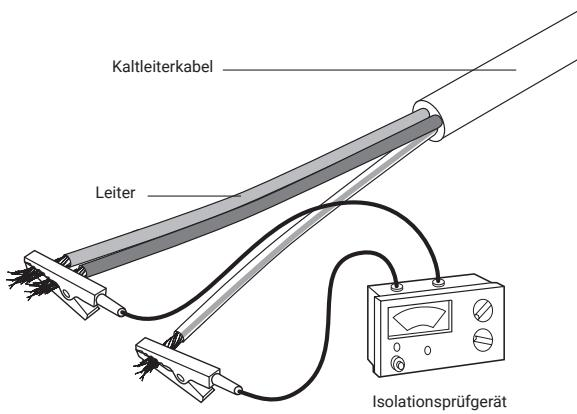
Der Isolationswiderstand sollte mit einem 2500 VDC (min. 500 VDC) Isolationsprüfgerät gemessen werden. Der Messwert muss  $\geq 100 \text{ M}\Omega$  sein. Tragen Sie alle Messwerte in das dafür vorgesehene Prüfprotokoll ein.
