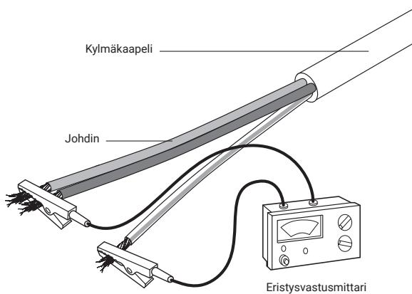
Mittaa eristysvastus 2500 V DC:n (vähintään 500 V DC) eristysvastusmittarilla. Lukeman tulee olla yli 100 MΩ. Kirjaa mitatut arvot toimitukseen sisältyvään mittauspöytäkirjaan.
