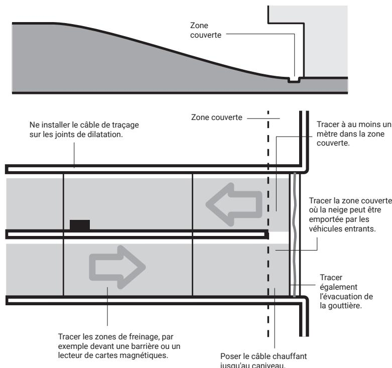
S'assurer avant tout que la zone à tracer est conforme aux données de l'étude. Définir l'emplacement des boîtes de raccordement et vérifier que les câbles sont suffisamment longs.
