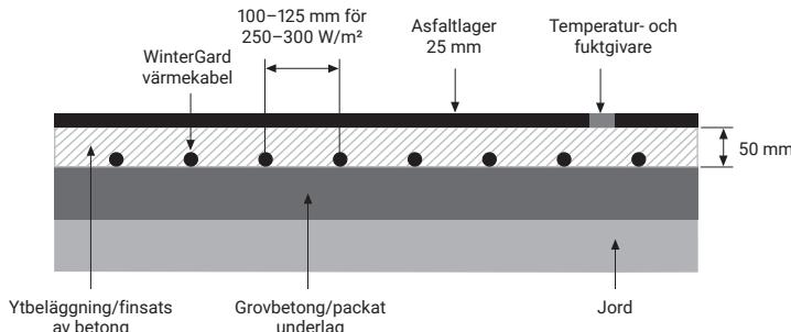
Om det inte går att fästa kabeln i armeringen, ska fästband eller annan fixeringsmetod (för asfalt fästband av metall) användas för att hålla cc-avståndet konstant.
