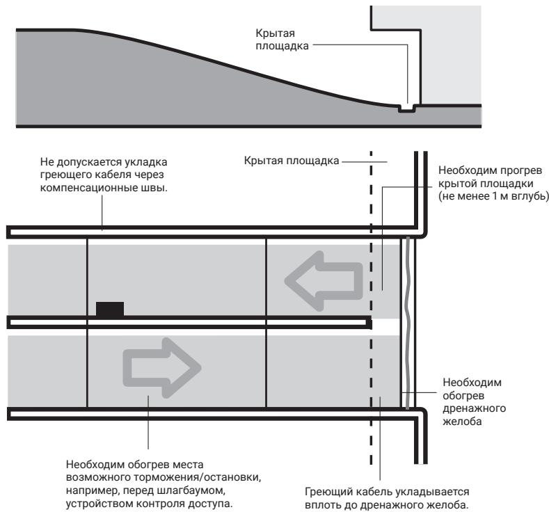
Перед укладкой кабеля убедитесь в том, что параметры обогреваемой площадки соответствуют расчетным данным. Определите места установок соединительных коробок и убедитесь, что длины кабелей холодного ввода (5 м) достаточно. Во избежание повреждения греющего кабеля острыми предметами, тщательно очистите основание. Помните, что кабель WinterGard нельзя укорачивать и наращивать.
