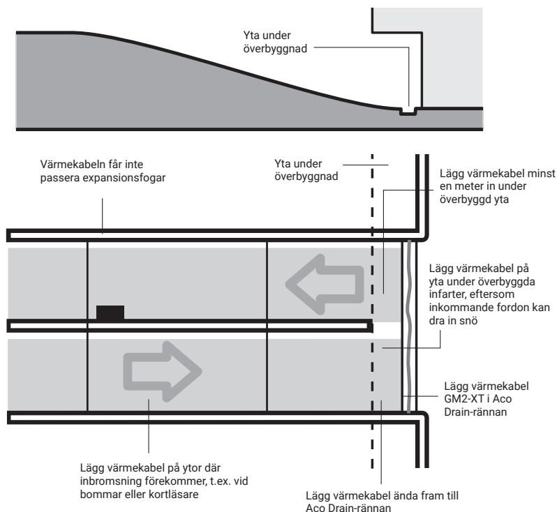
Se först till att den yta som ska värmas upp uppfyller alla relevanta krav. Fastställ var kopplingsboxarna ska installeras och kontrollera att anslutningskablarna är tillräckligt långa.
