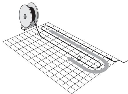
**⚠ ВНИМАНИЕ!** При укладке греющий кабель нельзя укорачивать и перекрещивать
