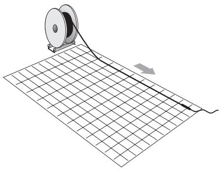
2 Koniec przewodu grzejnego (z przewodem zimnym) poprowadzić do punktu zasilania.
