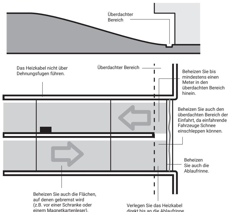
Vergewissern Sie sich, dass die zu beheizende Fläche den Angaben in der Projektieranleitung entspricht. Stellen Sie fest, wo die Anschlusskästen montiert werden und prüfen Sie, ob die Anschlusskabel lang genug sind. Die Länge beträgt 5 m. Reinigen Sie den Untergrund gründlich, bevor Sie mit der Montage beginnen, da scharfkantige Gegenstände das Heizkabel beschädigen können. Das WinterGard-Heizkabel darf weder gekürzt noch verbunden werden.
