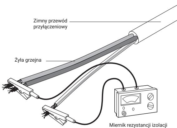
Rezystancję izolacji należy mierzyć za pomocą miernika rezystancji izolacji 2500 V (min. 500 V). Wynik powinien wynosić  $\geq 100 \Omega$ . Wszystkie wyniki pomiarów zanotuj w załączonym protokole pomiarowym.
