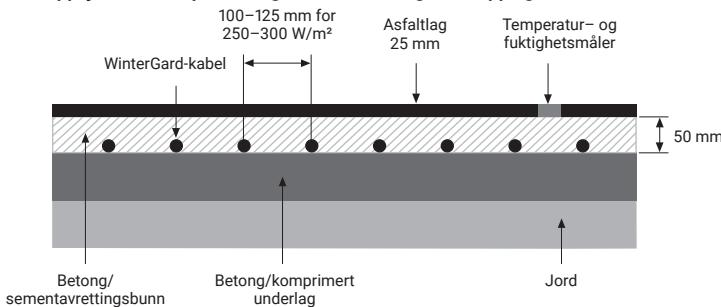
Hvis varmekabelen ikke kan festes til en armeringsmatte, skal installatøren bruke avstandsstykke av plast (for asfaltmetall VIA-SPACER) eller annen festemetode for å holde kabelavstanden konstant.
