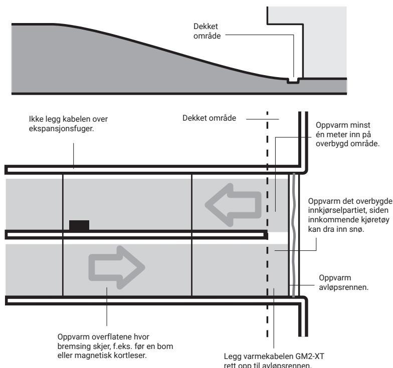
Forsikre deg først om at området som skal snøsmeltes/tines, oppfyller alle krav. Bestem hvor koplingsboksene skal installeres, og sjekk at kaldenden er lange nok. Lengden er 5 m.
