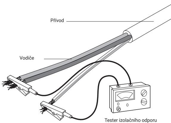
Izolační odpor by se měl měřit pomocí zkoušečky izolačního odporu 2500 V DC (minimálně 500 V DC). Hodnota by měla být vyšší než 100 MΩ. Všechny naměřené hodnoty zaznamenejte do dodaného "Záznamu o zkoušce instalace".
