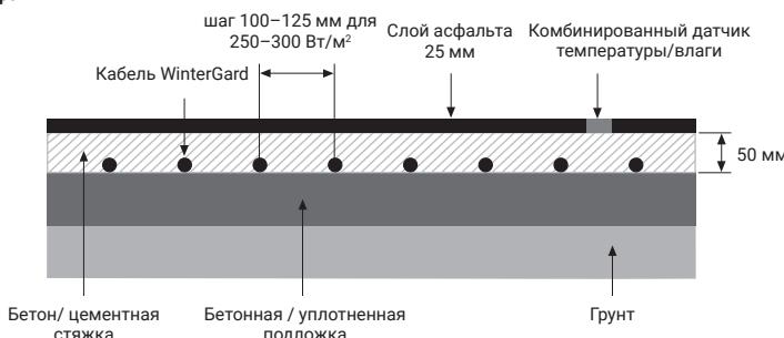
Если кабель не может быть закреплен на арматурной сетке, следует обеспечить шаг укладки при помощи монтажной ленты (для асфальта идеально подходит лента из металла VIA-SPACER) либо иным способом.
