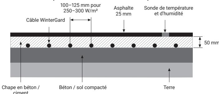
Lorsque le câble chauffant ne peut être fixé à une armature, utiliser les entretoises en plastique (pour l'asphalte VIA-SPACER métallique) ou une autre méthode de fixation pour maintenir l'écartement correct.
