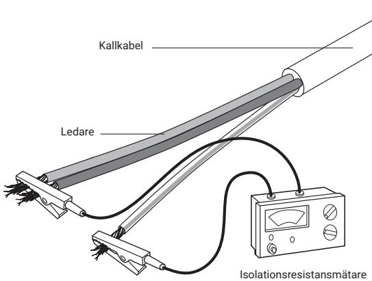
Isolationsresistansen mäts med en isolations-resistansmätare med minst 500 VDC provspänning, dock helst 2500 VDC provspänning. Uppmätt isolationsresistans ska vara minst 100 MΩ.
