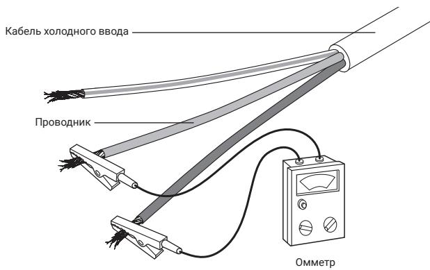
Внесите показания прибора в прилагающийся Протокол испытаний.
