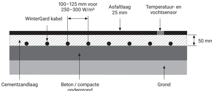
Als de verwarmingskabel niet kan worden vastgemaakt aan een wapeningsnet, moet de installateur de kunststof afstandhouders (voor asfalt metalen VIA-SPACER) gebruiken om de kabelafstand overal gelijk te houden.
