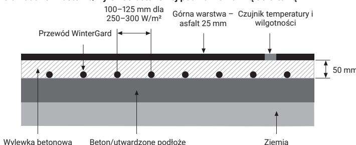
Jeżeli przewód grzejny nie może być zamocowany do zbrojenia, to instalator winien skorzystać z taśmy dystansowej z tworzywa sztucznego (do asfaltu metalowy VIA-SPACER) w celu utrzymania równomiernych odstępów między przewodami.
