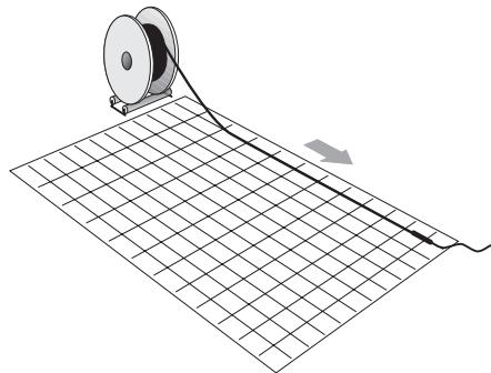
2 Umístěte topný kabel (s přívodním vodičem) do místa připojení napájecího přívodního kabelu.
