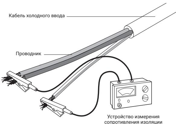
Проверку сопротивления изоляции (мегаомметром) следует проводить на уровне напряжения 2500 В (минимум 500 В) постоянного тока. Показания сопротивления изоляции должны превышать 100 МОм. Внесите показания прибора в прилагающийся Протокол испытаний.
