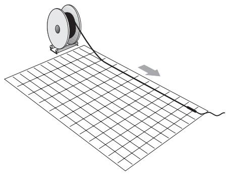
**2** Positionner le câble chauffant (muni de la connexion froide) jusqu'au point de raccordement électrique.
