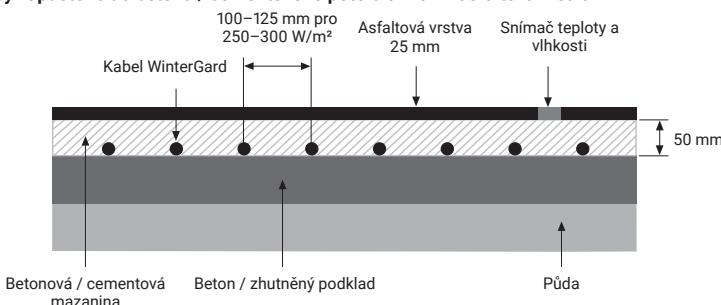
Pokud nelze topný kabel připevnit k armovací síti, měl by montér použít plastovou distanční podložku (pro asfaltový VIA-SPACER) nebo jiný způsob upevnění, aby byla zachována jednotná vzdálenost kabelů.
