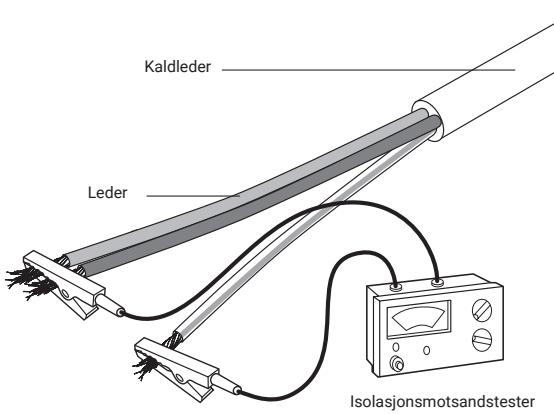
Isolasjonsmotstanden skal måles med hjelp av en isolasjonsmotstands-tester på 2500 Vdc (500 Vdc minimum). Avlest tall skal være mer enn 100 MΩ. Registrer alle målte verdier på det vedlagte skjemaet for installasjonstesting.
