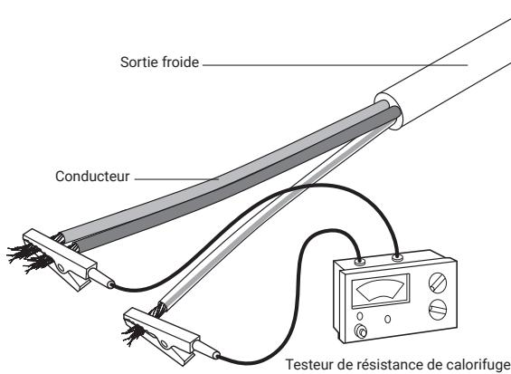
La résistance du calorifuge se mesure à l'aide d'un testeur 2500 V cc (minimum 500 V cc) conçu à cet effet. La valeur relevée doit être de minimum 100 MΩ.
