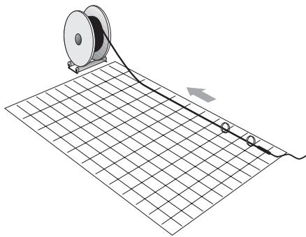
**⚠ ВНИМАНИЕ!** При укладке греющий кабель нельзя укорачивать и перекрещивать
