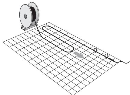
4 Vid slutet av varje rak kabelpart ska kabeln krökas 180 grader och nästa kabelpart läggas i motsatt riktning och med rätt cc-avstånd. Fortsätt att fästa värmekabeln var 100:e mm, tills hela kabeln är fast och hela ytan som ska värmas upp är försedd med kabel.
