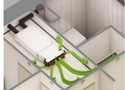
Koncept Renovent Sky s rozdělovacími boxy vybavených tlumičem hluku
