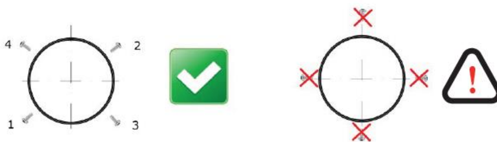
Obr. 4.1. Připojení vzduchovodů a armatur ke zvlhčovači (je zakázáno šroubovat samořezné šrouby na vodorovné a svislé ose – může dojít k poškození vnitřních částí zvlhčovače, samořezné šrouby je nutné zašroubovat pod úhlem 45 stupňů z vodorovné a svislé osy)
