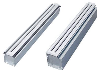
Difuzory LINE se skládají z přípojovacího tlumícího boxu a vlastního sádrového difuzoru. Difuzory LINE se dodávají v délkách 0,625, 1 a 1,25m. Difuzory jsou v provedení 1, 2 a 3 slotovém. V provedení klasickém, či s Coanda efektem. Difuzory je možné navzájem spojovat a vytvářet nekonečné linie a tvary na stropě či na stěně.
